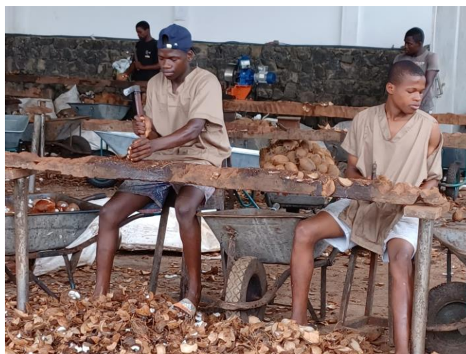
Figura 9 – Retirada da casca de coco (noz) na unidade industrial de processamento do coco
