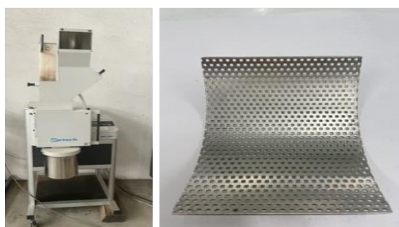
Figura 18 – Moinho e crivo utilizados na moagem das amostras
