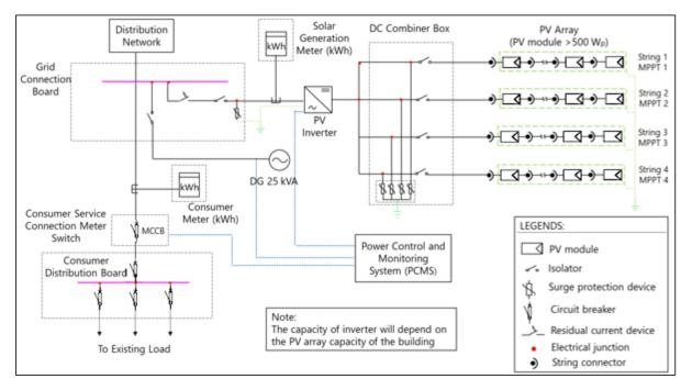
Figure 18: Single line diagram of rooftop PV system for Direção do Ensino Primário
